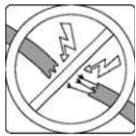
Zkontrolujte, zda nejsou kabely poškozeny.
