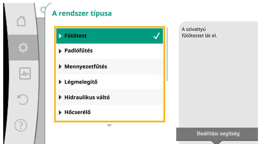
Fig. 47: Példa: a „Fűtőtest” rendszertípus
