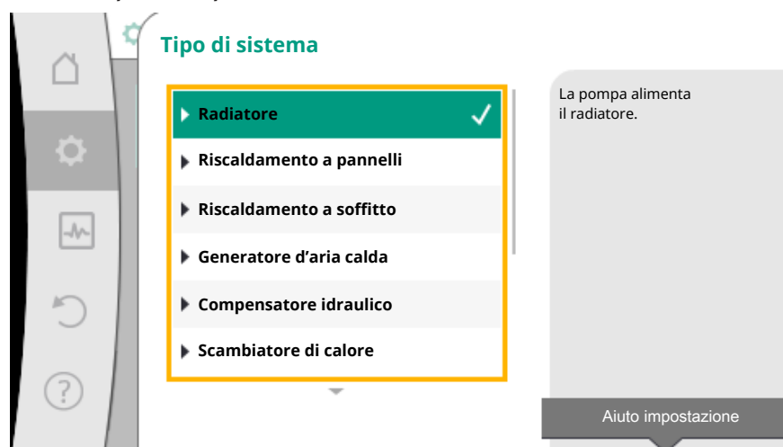
Fig. 47: Esempio tipo di sistema "Radiatore"
