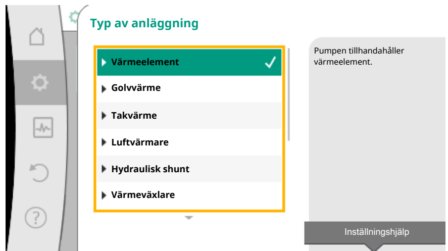
Fig. 47: Exempel, systemtypen "Värmeelement"
