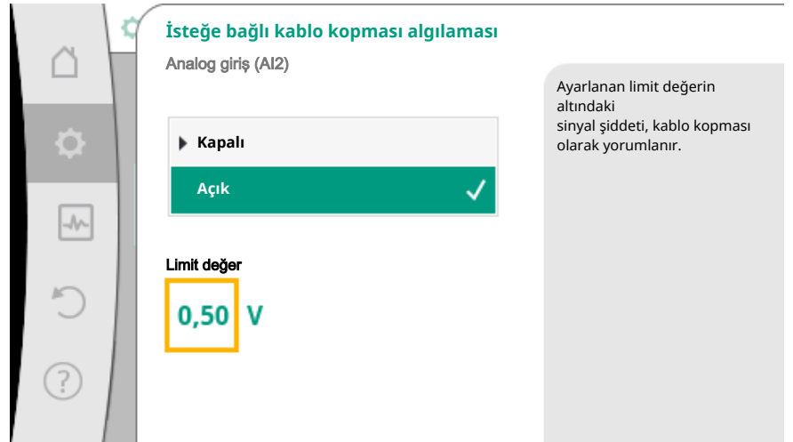
Fig. 72: Limit değeri kablo kopması
