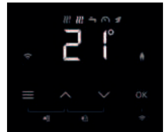
3,5-palcový 7 segmentový displej s dotykovými tlačidlami
