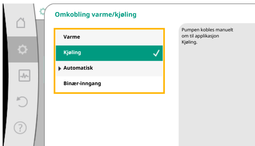
Fig. 55: Omkobling varme/kjøling_ Kjøling
