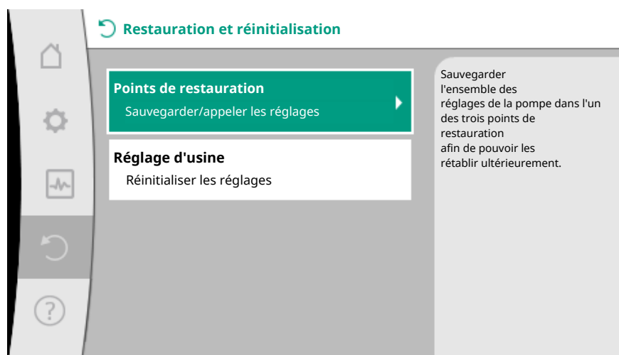
Fig. 85: Points de restauration
