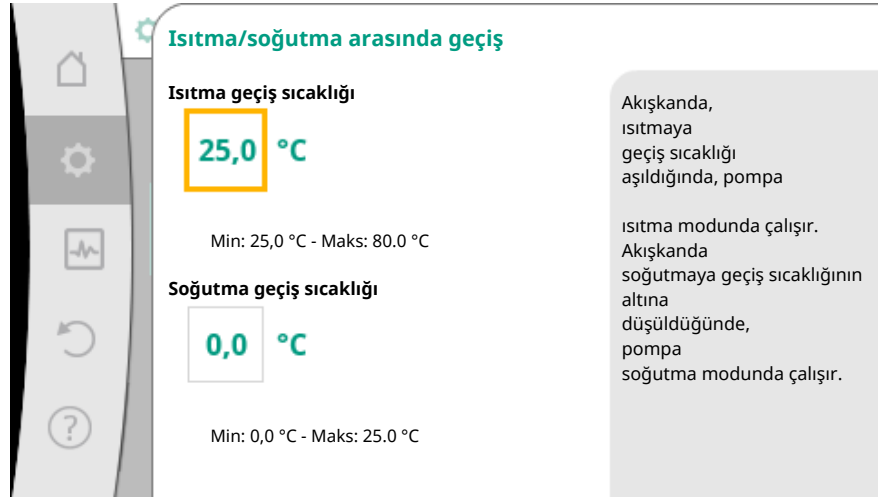
Fig. 57: Isıtma/soğutma_geçiş_sıcaklıkları arasında geçiş
