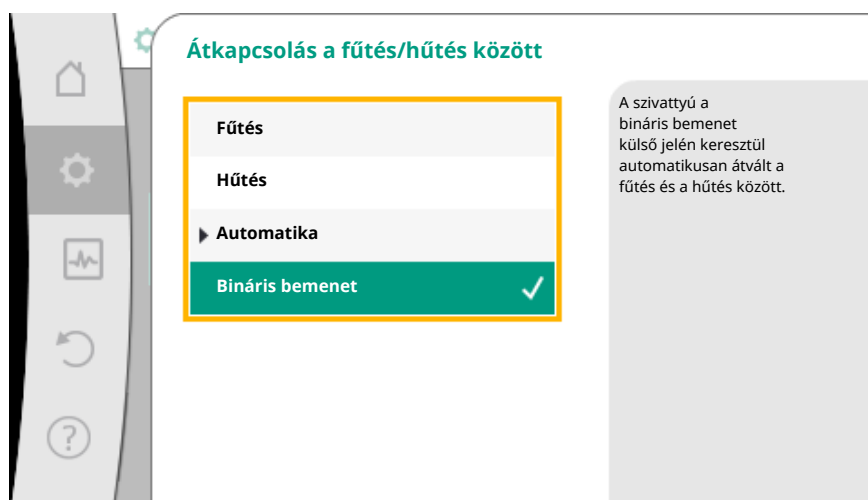
Fig. 58: Átkapcsolás a fűtés/hűtés között_Bináris bemenet
