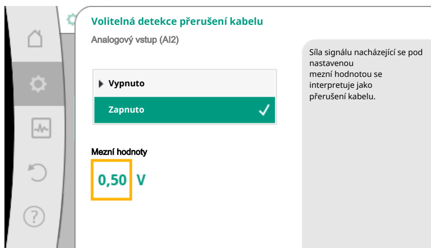
Fig. 72: Mezní hodnota – přerušení kabelu
