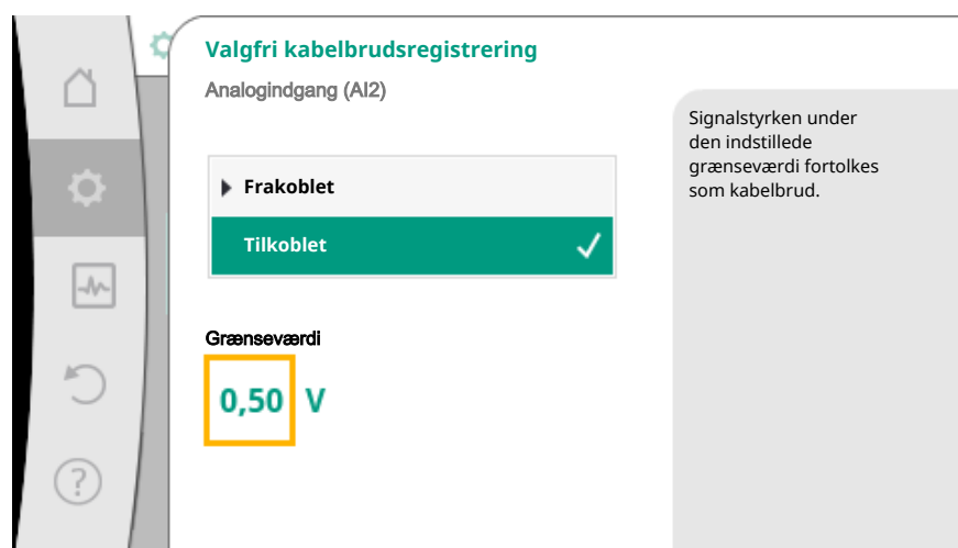
Fig. 72: Grænseværdi for kabelbrud
