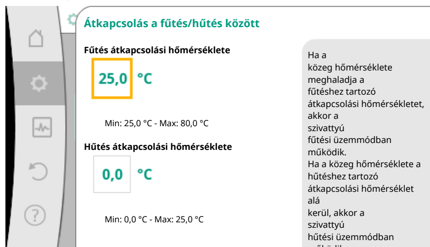
Fig. 57: Átkapcsolás a fűtés/hűtés között_Átkapcsolási hőmérsékletek
