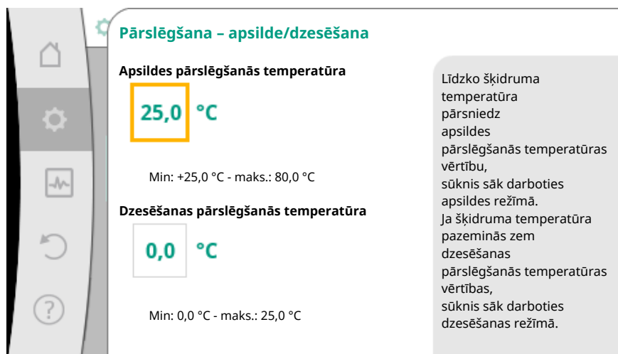
Fig. 57: Pārslēgšana – apsilde/dzesēšana_Pārslēgšanas temperatūra
