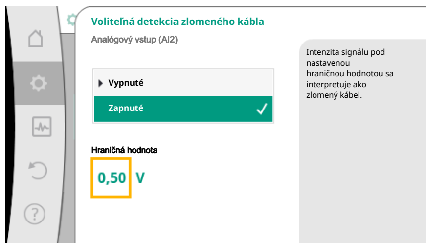
Fig. 72: Hraničná hodnota zlomeného kábla
