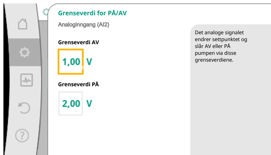
Fig. 74: Grenseverdier for AV/PÅ-styring via analogsignaler
